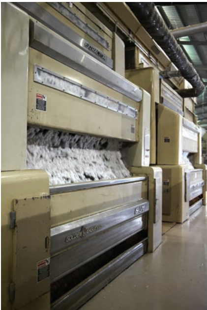
En el despepitadero se separan las fibras de algodón de la semilla.
